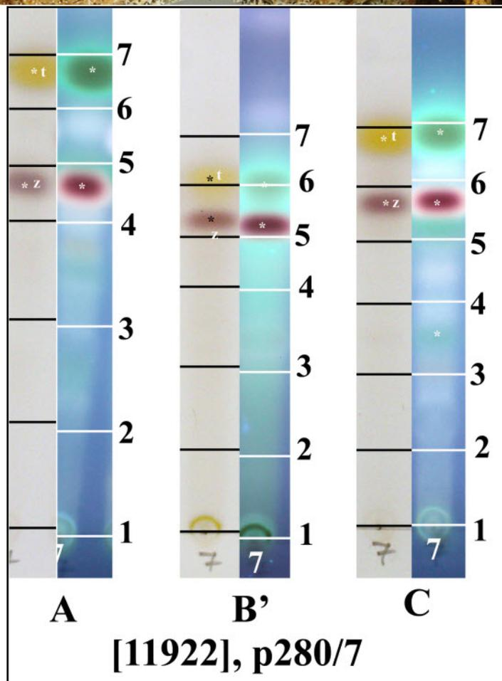
HPTLC in den Laufmitteln A, B' und C nach Säurebehandlung bei Tageslicht und 366 nm UV-Longwelle. 1: Start, 4: Position von Norstictinsäure, 7: Position von Atranorin, t: Tenuiorin, z: Zeorin
